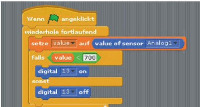
Abbildung 9: Scratch for Arduino Code
